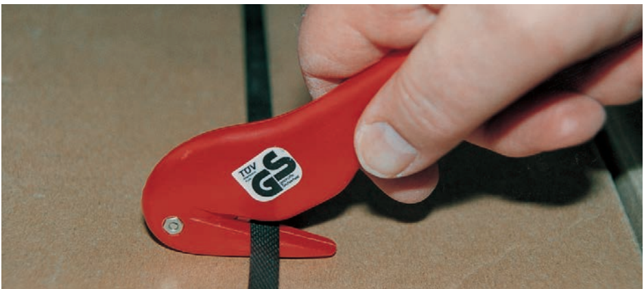
Bild 11: Folienschneider/Folienmesser zum Schneiden einer Bandverschnürung.
